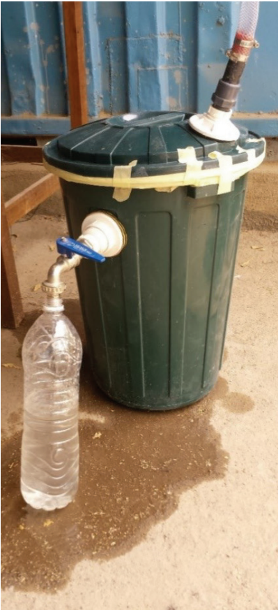
▲ Prototype de filtre à usage domestique
